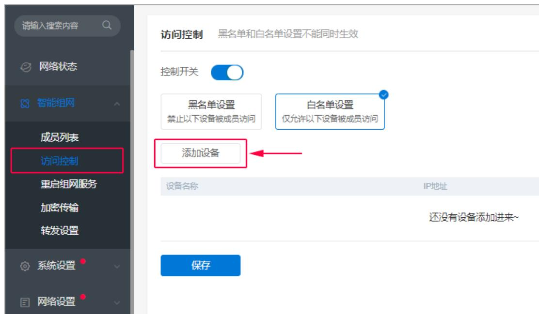
开启控制开关，选择控制类型，点击“添加设备”，勾选对应的设备点击“添加”即可。
