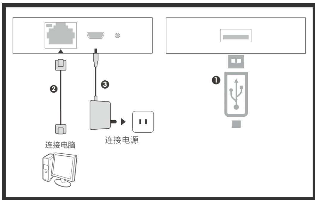
①将 3G/4G USB 上网适配器接入蒲公英 X1 侧面 USB 接口；
